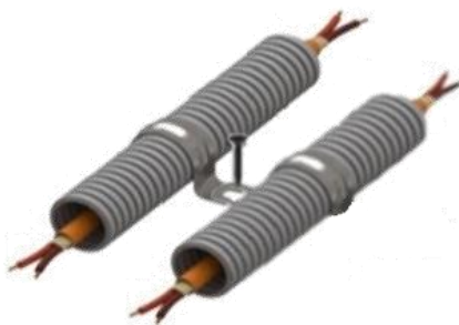
Рис. 3.4.3 Пример прокладки двух параллельных линий
