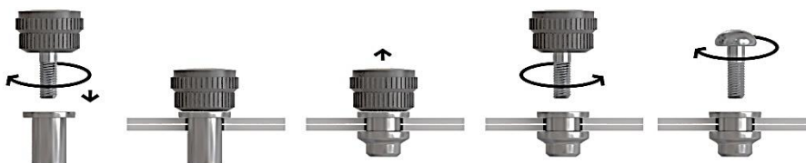
Рис. 4.4.1 Последовательность монтажа заклепки резьбовой с винтом
