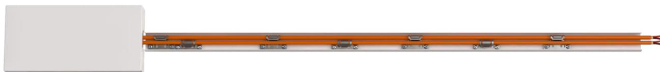
Рис. 2.3.3 Пример прокладки 2-х кабелей в одном кабель-канале 25x25 с применением ДМОУ-1К-М
